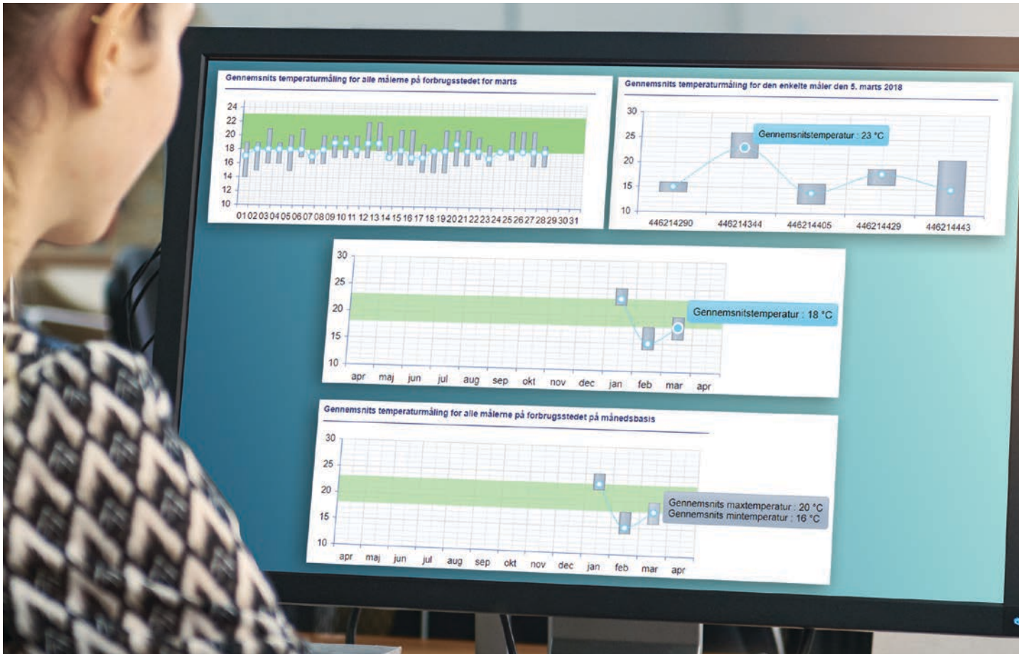
Øverst tv: Drill down på en måned giver en gennemsnitsvisning pr. dag. Øverst th: Drill down på en dag giver aflæsningerne for den enkelte måler. Midten: Gennemsnitskurve som ved mouse over viser gennemsnitsværdien. Nederst: Mouse over på søjlen giver max og min temperaturerne.
