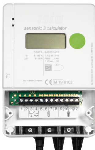
Unità di calcolo. La cover rimovibile cela la morsettiera, la numerazione dei terminali e i passacavi per il cablaggio
